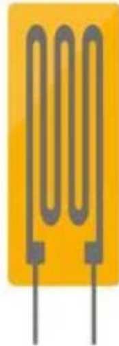
Ilustración 1. Representación esquemática de una galga de extensometría (Fuente: HBM)
