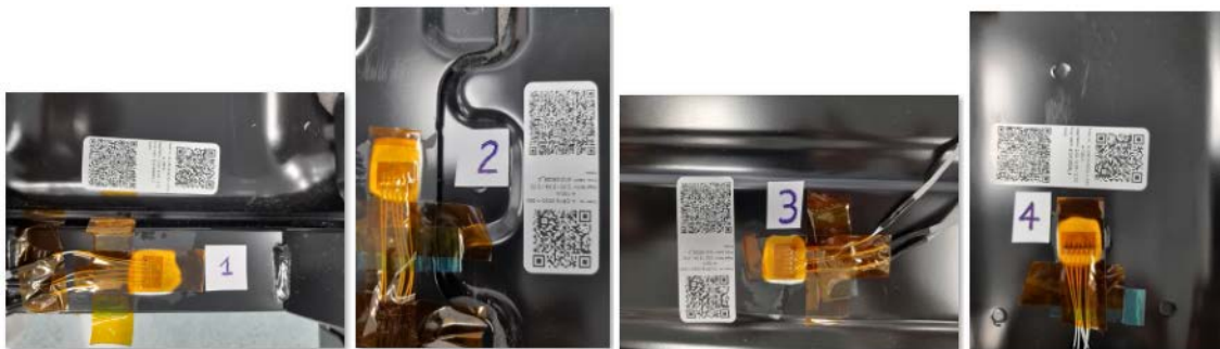
Ilustración 9. Rosetas pegadas al sustrato metálico
