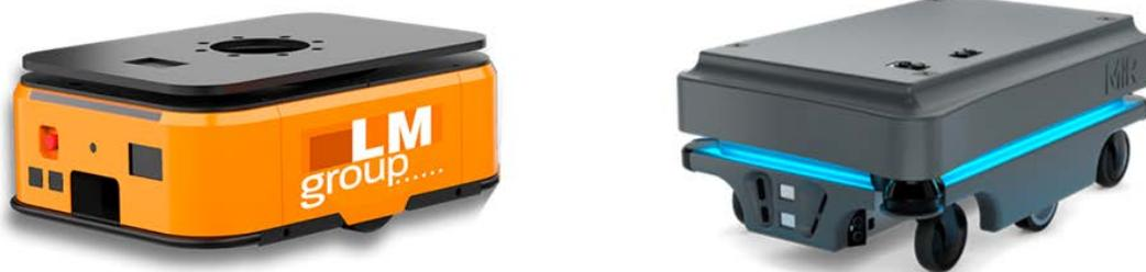
Figura 1 Robot AGV de LM group [LM] (izda). Robot AMR de MiR (dcha)
