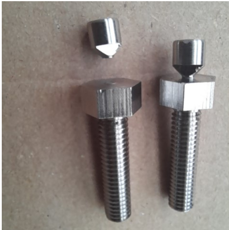
Ilustración 2. Fusible roto y fusible sano
